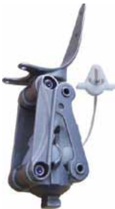
MODELO 3: Articulação do Joelho da Barra do Prosthetics 4 para o Joelho - modelo 3K23T - 654g - titânio - peso do corpo a suportar: 100kg - US$400,00-500,00 - Ângulo aprox. 110° da flexão do Joelho - Altura (centro à borda superior) 18mm do Joelho - Fabricante: Trading Company - Distribuidor: Fujian Prosthetics Center - Porto de Fuzhou.
