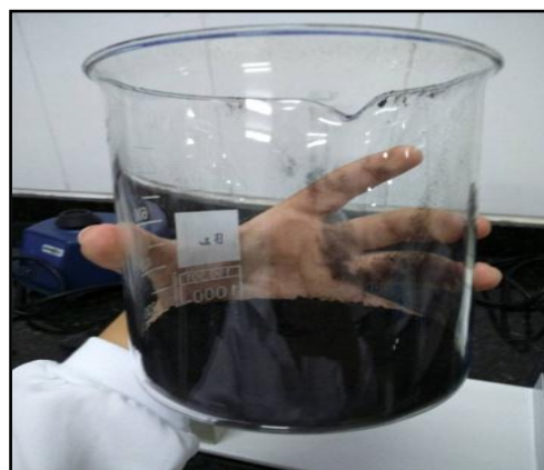
Figura 4: Carvão ativado obtido de 15 caroços de manga.
