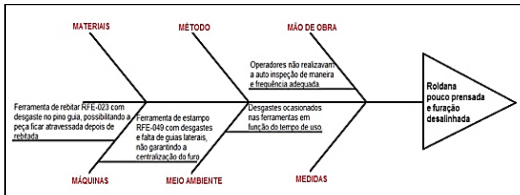
Figura 10: Diagrama de Ishikawa com o eito provocado na roldana analisada
