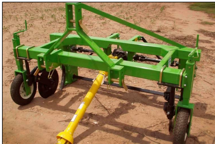
Figura 2. Arrancadora de cebollas AC160, marca Escañuela.
