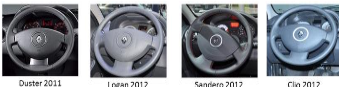
Figura 2 - Aplicação de um mesmo volante em carros de diferentes segmentos pela Renault do Brasil
