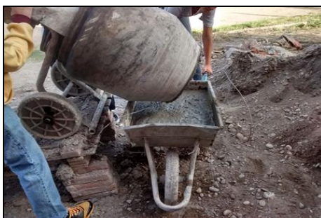
Figura 2. Pastón completo para moldeo de probetas.
