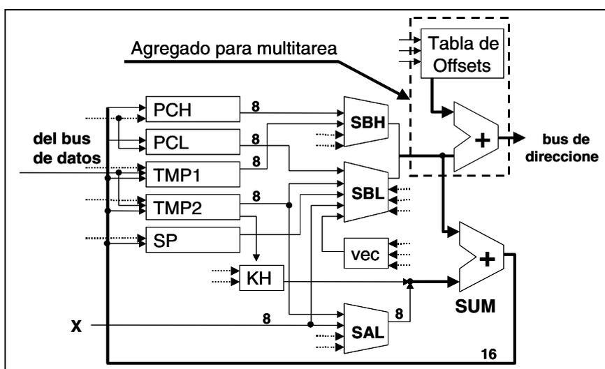
La figura muestra las modificaciones a realizar a unidad de cálculo de direcciones de un MC6805 mono-tarea [], y evidencia que sólo es necesario agregar un sumador y una tabla de constantes que genere esos offsets.
