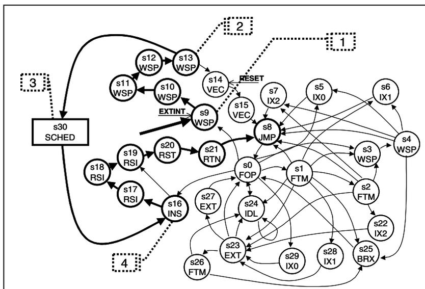
La figura muestra las modificaciones a realizar a la máquina de estados de control de un MC6805 mono-tarea [], y evidencia que sólo es necesario agregar un nuevo estado (s30-SCHED) a los 30 estados pre-existent (s0 a s29) para poder realizar la conmutación de contexto.
