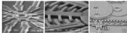
FIGURA 20: Micro-motores e micro-engrenagens
