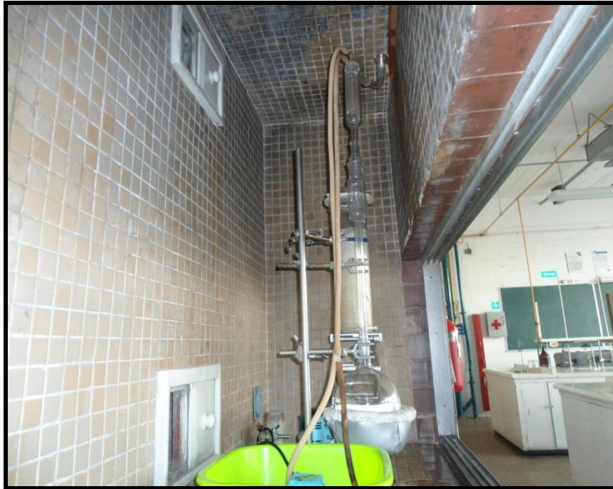
Figura 2. Dispositivo de extracción tipo Soxhlet para procesar el material biológico
