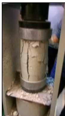
Figura 3. Ensayo a compresión.
