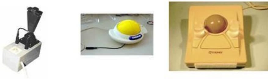
Imagen 5. Emulador de mouse para barbilla, mouse de bola, mouse de bola para utilizar con el mentón
