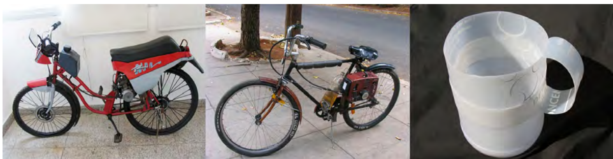
Fig. 24: Distintos casos de reinvención relevados por Ernesto Oroza en Cuba: en los dos primeros se puede observar el montaje de partes de artefactos distintos, lo que le da mayor complejidad estructural y funcional a los nuevos vehículos. En el 3er. caso, la operación se hace sobre materia y forma para lograr una nueva función, a partir de la affordance que permite percibirlo como recipiente.
