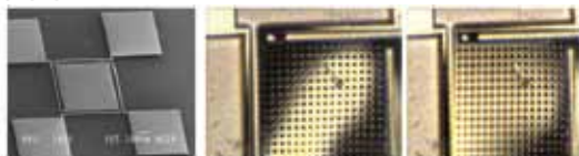
FIGURA 11: Projeto de micro-espelhos de Nitinol com suas bases de apoio em forma de vigas
