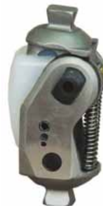
MODELO 1: Articulação do joelho 3K22T da linha central do Prosthetics - Membro artificial - 378g - titânio - Ângulo aprox. 120° da flexão do joelho - Altura (centro à borda superior) 37mm do joelho - peso do corpo a suportar: 100kg - US$200,00-300,00 - Fabricante: Trading Company - Distribuidor: Fujian Prosthetics Center - Porto de Fuzhou.
