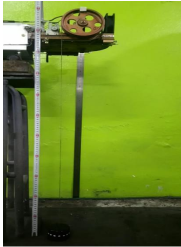
Figura 3. Masa de 150 g suspendida verticalmente por hilo de masa despreciable y sujeta sobre polea
