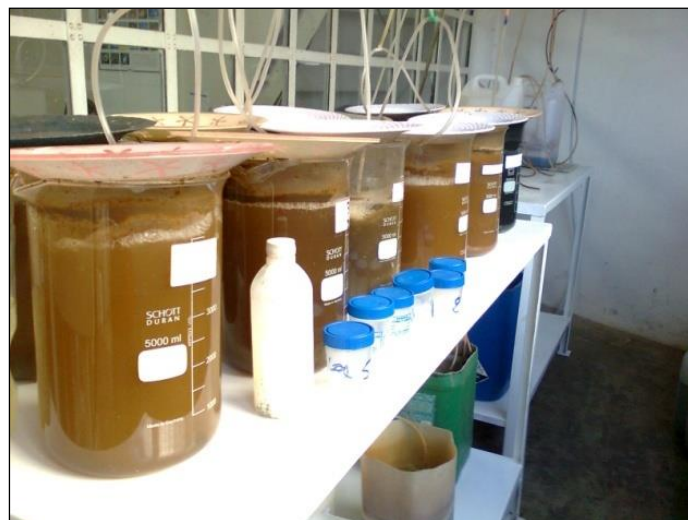
Figura 1. Plantas Piloto de Lodos Activados Tipo “Batch” o SBR. Montadas en FABRIPAR S.A
