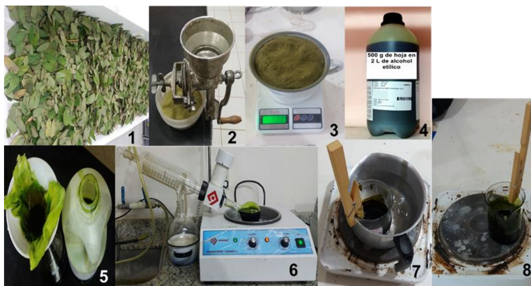
Anexo E: Preparación del extracto etanólico de Bauhinia forficata Link. (1) Secado. (2) Proceso de pulverización con ayuda de molino manual. (3) Hojas pulverizadas y pesadas. (4) Disolución en 2 L de etanol al 70%. (5) Filtrado. (6) Concentración del extracto con ayuda de evaporador rotativo, (7) baño maría y (8) calentamiento directo sobre la placa.
