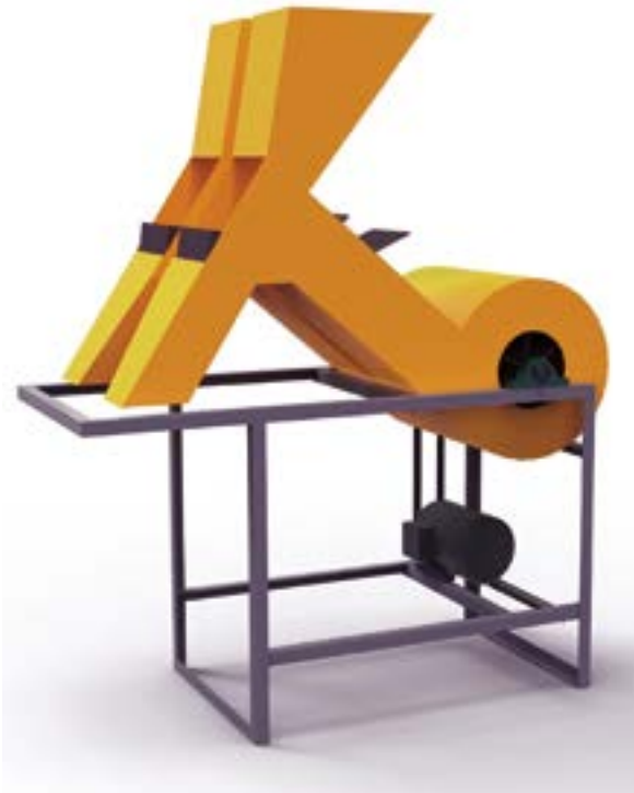
Prototipos de trilladora y venteadora desarrolladas por el equipo de IPAF NOA (INTA).
